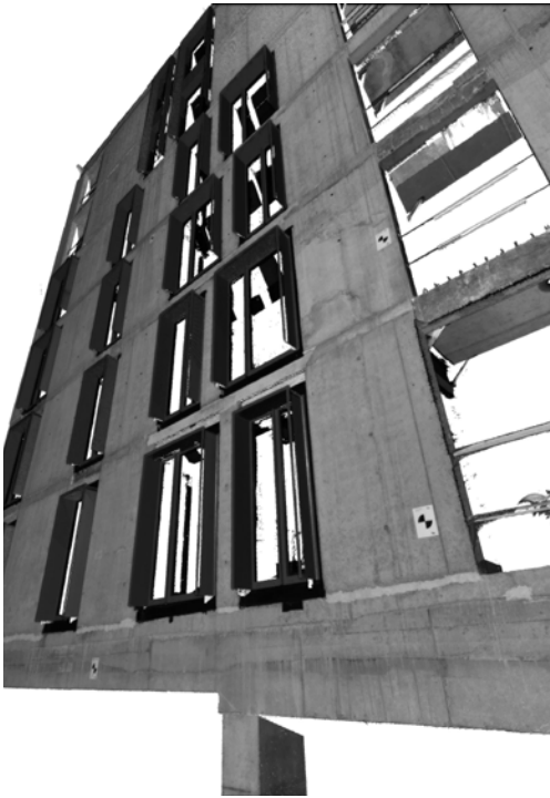
▲ Puntenwolk verkregen via laserscanning (referentiemodel).
